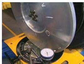
◆測定ディスクの振れを確認し、その誤差を0.3mm以下に整える作業です。ホイールの角度のすべてがこの測定ディスクに0.3mm以下の精度で現れます。
