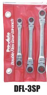
ギア数72山、送り角5度のギアにダブルフレックス機構を採用した高効率ギアレレンチ。フレックス機構は180度首振りOKで、12段階15度の角度調整で固定できるロック機構を採用しているためハンドルの振り幅が制限される狭いエンジンルーム内でも機能性は抜群です。また特殊な構造によりギアが滑らず、本締め作業が可能です。
