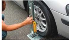
測定ゲージAのホイールサイズ調整ボルトを緩めて、測定車のホイールサイズに合わせる。レーザー測定器をキャンバ用にセットする。測定ゲージAをホイールのリムに垂直にあてる。
