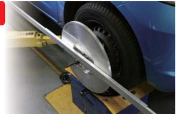
■簡易式テスタのほとんどが、ホイールクランプ方式に対して、本製品はハブナット(ハブボルト)接続方式を採用。
