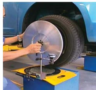
◆オプション部品のダイヤルゲージを用いて手動ランナウト補正を行っている様子。
