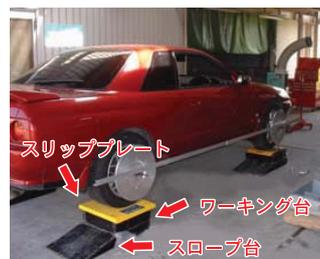
◆測定車と床面の間には、車高の低い車を乗り上げ、ジャッキアップしやすいよう、スロープ台と、車体の下に入って調整がしやすいワークキング台にて、車体をセットすると、測定調整がしやすい。ホイールアライメントをしない時は、フロアを別利用できます。
