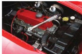
スパークプラグやシリンダーヘッドボルトの締め付けに最適です。
