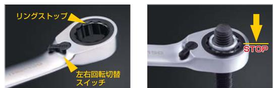
送り角5度・ギア数72山、高性能ギアレレンチのツイスト型ロングタイプのギアレレンチ。フラットな左右回転切替スイッチは、ワンフィンガーで簡単に操作できます。またメガネ部はストップバー付き(リングストップ)のためナットを確実にホールドし、作業性が大幅にアップします。
