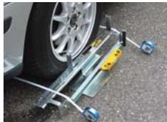
反対側に測定ゲージAをセットする。普通車の場合だと、「普通車」矢印をホイールのほぼセンターにする。メジャーで前後の数値を読み取る
