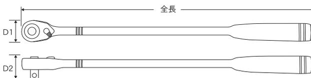
中空構造で軽量型。全長が440mmの超ロングタイプ。
