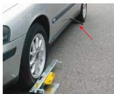
前輪右側の測定。レーザープレートをドアなどのプレスラインに沿って左右同じ位置に取り付ける。レーザー測定器をゲージA、Bの側面のセンターに取り付ける。レーザーを照射する。
